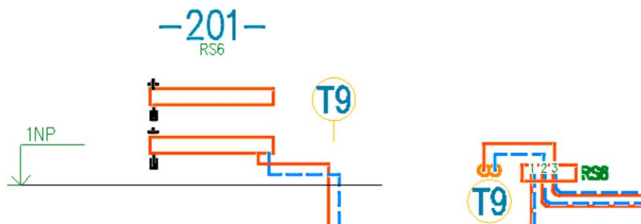
Obr. Ukážka automatického vykreslenia rozdeľovačov z pôdorysu do schémy pre podlahové vykurovanie.
